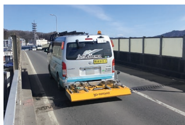
床版キャッチャー調査状況
